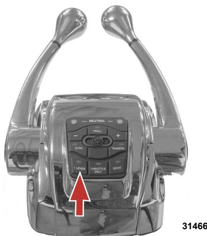
Einzelhebelmodus-Taste mit Kontrollleuchte
